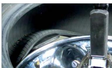
Демонтаж нижнего борта шины выполняется быстро и просто с помощью отжимного диска.
