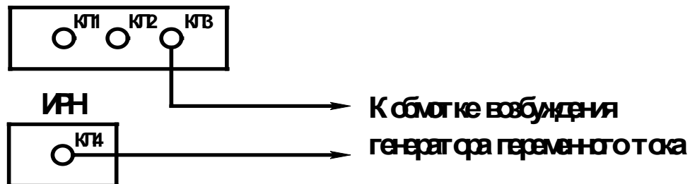
Рисунок 15 Схема подключения обмотки возбуждения генератора.
