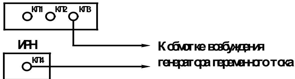
Рисунок 15 Схема подключения обмотки возбуждения генератора.
