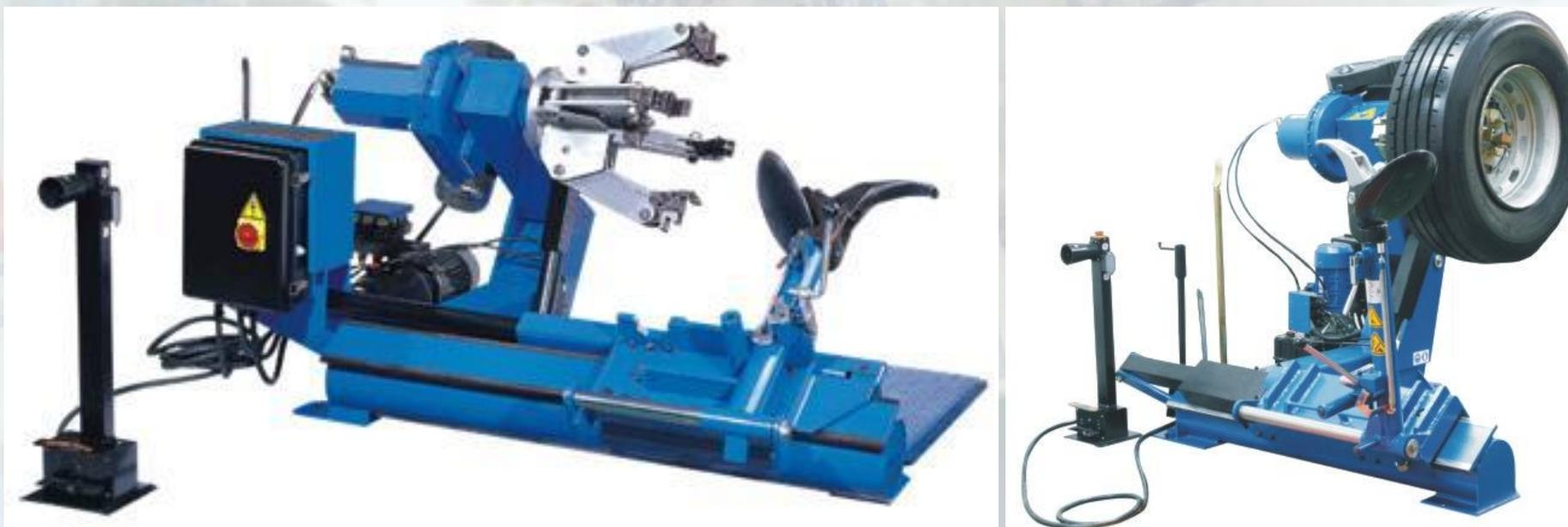
«ШМГ-1Н - Шиномонтажный станок для колес автобусов, грузовых, дорожно-строительных и с/х машин посадочным диаметром 14-26 дюймов» и «ШМГ-2 Шиномонтажный станок для демонтажа и монтажа колес автобусов, грузовых, дорожно-строительных, сельскохозяйственных машин и тракторов с посадочным диаметром от 14 до 42 дюймов»
