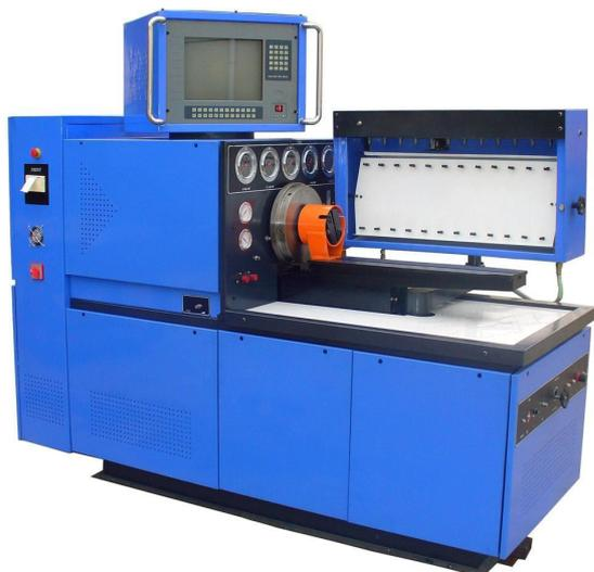
Стенд 05Э предназначен для диагностики и регулировки ТНВД отечественного и импортного производства с механическим и электронным управлением до 12 секций включительно.
