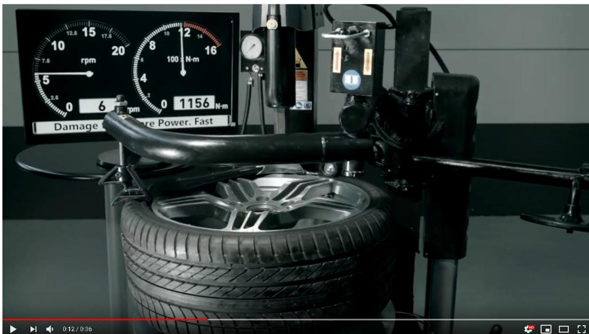
2. Далее с 20 секунды показано правильное положение верхнего борта шины, он утоплен прижимом "третьей руки" в монтажный ручей, в процессе монтажа нет превышения порога сопротивления и стенд на максимальной скорости производит монтаж шины
