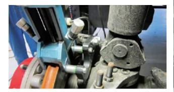
МАD DA9000 специально разработан для работы с большими в диаметре и широкими тормозными дисками, преимущественно грузовых автоомбилей и прицепов, а также автобусов.
