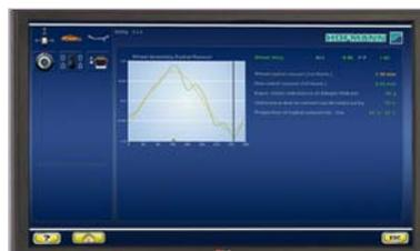
Диагностика радиального биения колеса выполняется одновременно с измерением дисбаланса, не снижая производительности стенда. Высокое радиальное биение автоматически определяется при диагностике обода и обеспечивает определение причин вибраций, вызванных отклонениями от правильной геометрической формы обода и шины (только geodupa 8200-2p и 8250-2p).
