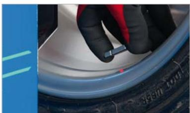
Точечный лазерный указатель обеспечивает быструю, точную и удобную установку клеевого груза на ободе. Место установки груза указывается в нижней части обода, что обеспечивает удобную, быструю, точную и безошибочную работу оператора.
