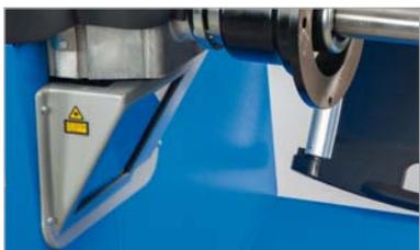
Сканер обода автоматически вводит диаметр обода, расстояние, а также количество и расположение спиц. После этого автоматически выбирается программа балансировки, тип грузов и места их установки. Вместе с автоматическим вводом ширины обода УЗ детектором Smart Sonar™ это делает станд идеальным решением для СТО с высоким объёмом работ.
