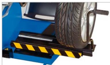
Модерный подъёмник колеса обеспечивает лёгкую и быструю работу с колёсами массой до 70 кг. Колесо автоматически поднимается на высоту, использованную при последней балансировке, а затем платформа автоматически опускается в исходное положение. Это снижает время полного цикла «с пола на пол».
