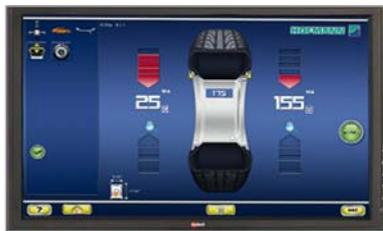
Высоко интуитивный и быстрый сенсорный экран монитора с цифрами большого размера, цветными указателями места установки грузов и PLATINUM интерфейсом пользователя – повышает уровень интуитивности и эргономичности.
