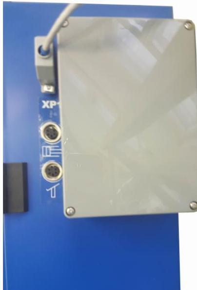
Рисунок 8 – Блок радиомодуля
