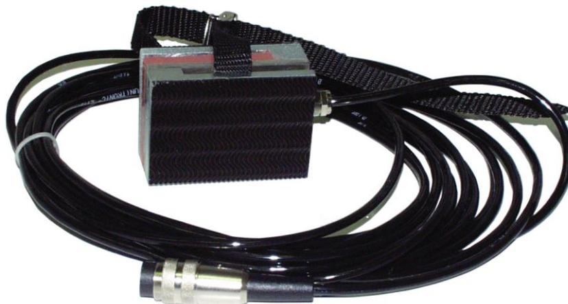
Рисунок 9 – Датчик силы ДС
