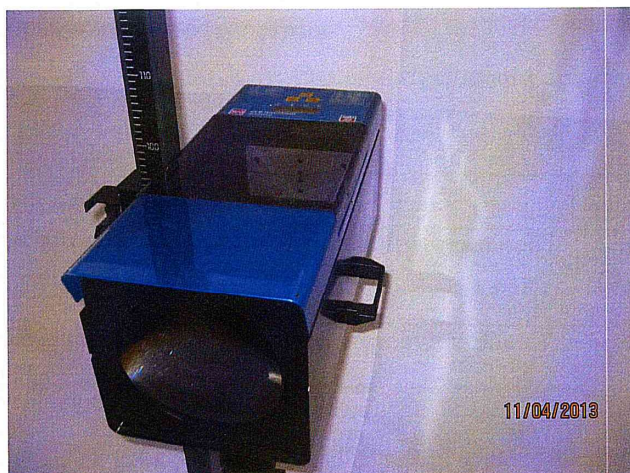
Рисунок 1 - Приборы проверки фар модели ОПК.
